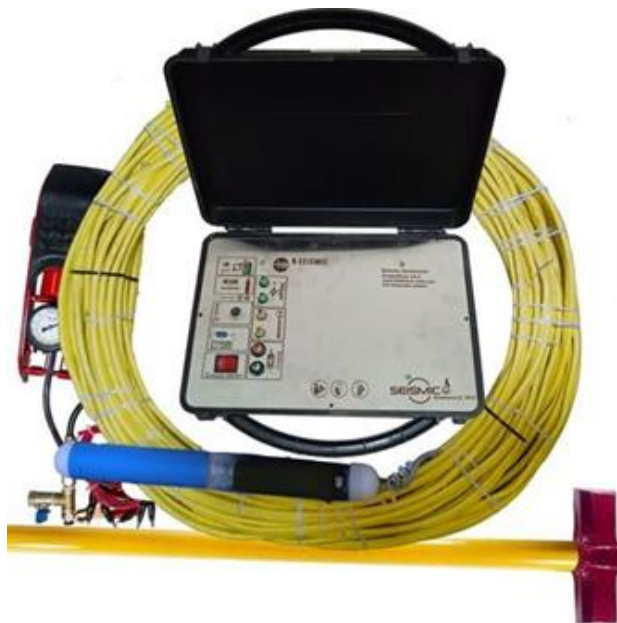
شکل ۱۰ - دستگاه لرزه نگار و سوند مورد استفاده در عملیات
